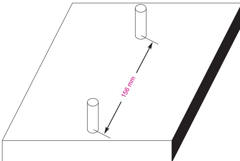
1. Крепежные отверстия имеют диаметр 6.4 мм и удалены друг от друга на 156 мм.
